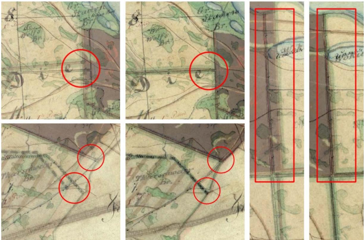
Abb. 6: Im Hintergrund liegt die Karte von 1777, überlagert mit einer Transparenz von 50% die Karte von 1857. Die Kreise markieren Punkte vor und nach der Georeferenzierung.
