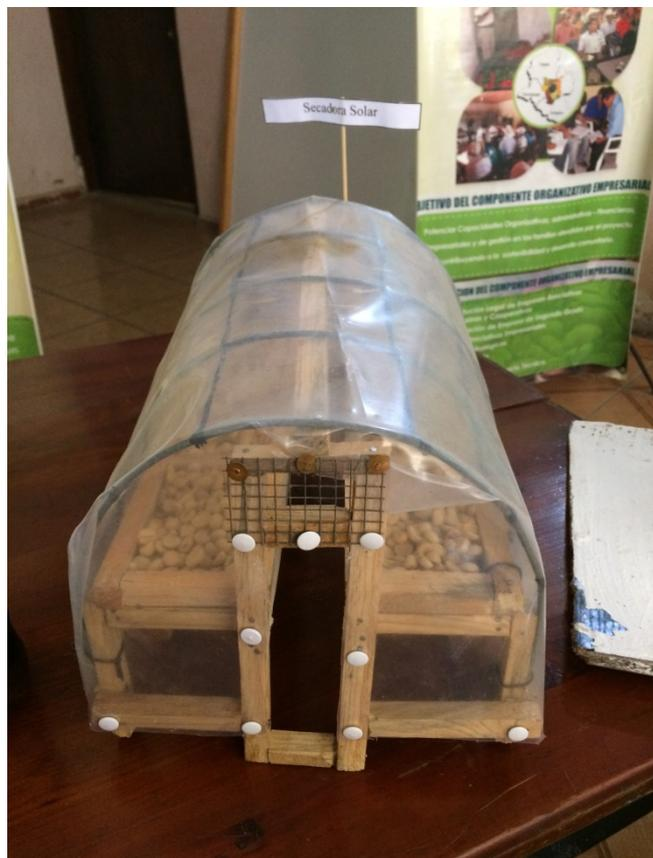
**Abb. 5: Modell eines Gewächshauses für die Kaffeetrocknung** (BRADEMANN 2017)
