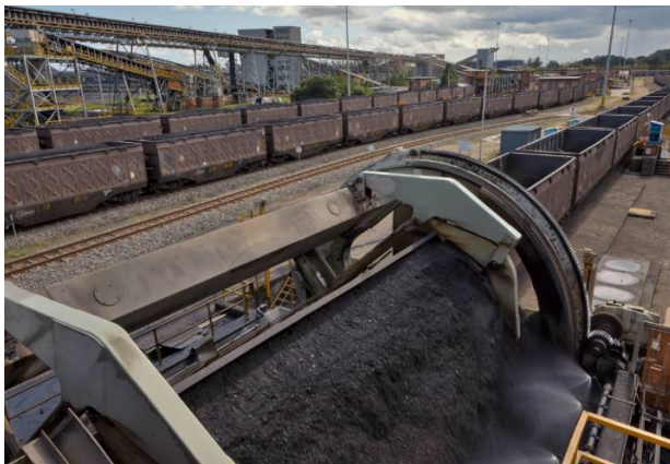
Abb. 9: Tandem tippler bei der Entladung (NIEDER 2016)
