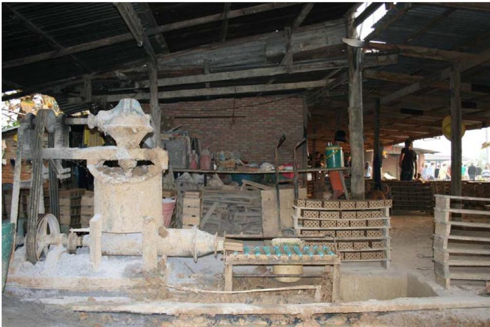
Abb. 5: Maschine zur Pressung der Ziegelrohlinge (KELLY 2011)
