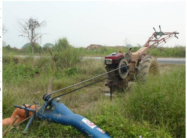
**Abb. 3: Universalmotor beim Einsatz als Pumpe** (KULKE / SUWALA 2011)
