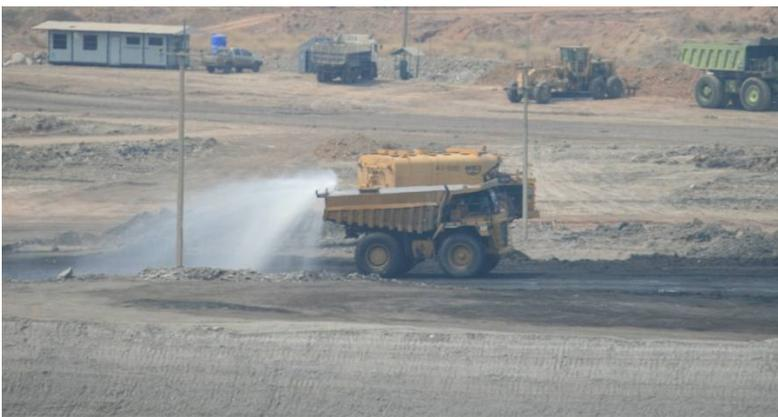
**Abb. 13: Staub-/ Sandbindung über Spritzwasserfahrzeug (KELLY 2011)**
