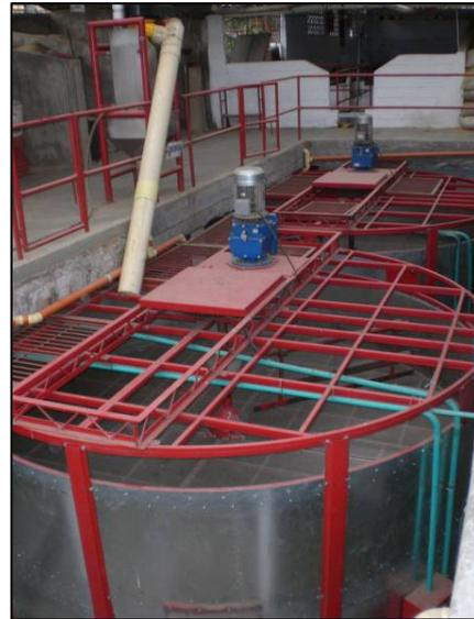
**Abb. 12 (links): Anlage zur Trennung der Qualitätsstufen (HÖHNE 2012)**
