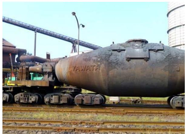
**Abb. 7: Ein *Torpedo* aus der *Yawata*-Ära zum Transport von Roheisen**
